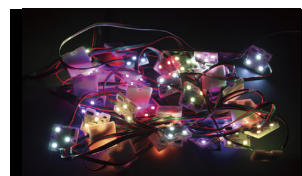
LED モジュール、SMD5050 型、3 球 1 アドレス x40 モジュール、RGB (フルカラー)、CCR (LOR) 互換、プラスチックケース、20cm ピッチ
