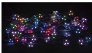
LED モジュール、SMD5050 型、 3 球 1 アドレス x50 モジュール、 RGB (フルカラー)、LOR 互換
